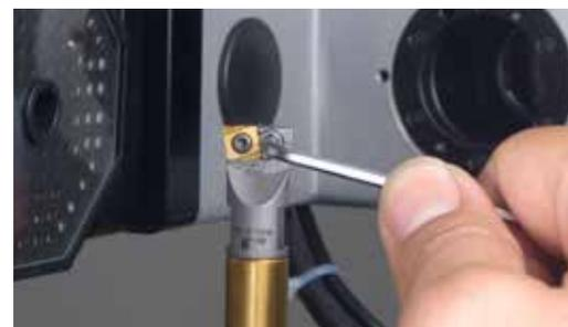
Die patentierte Werkzeugstruktur ermöglicht unter Verwendung einer exzentrischen Schraube eine geringfügige Größenänderung in Durchmesserrichtung. Hervorragend geeignet für Anwendungen mit Einzelbohrwerkzeugen, Tiefbohrwerkzeugen, Spezialwerkzeugen usw. einfache Kontrolle der  $\mu$ -Genauigkeit.
