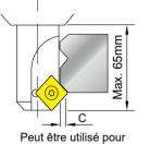
Peut être utilisé pour réaliser des chanfreins avant arrière Max. 2mm CØ16-Ø28
