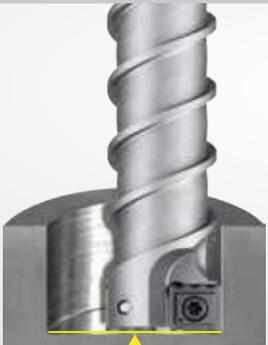
Eseguire "un'ulteriore interpolazione" dopo aver raggiunto la profondità.
