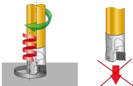
**Fase 1:** Scegliere la velocità di taglio, la velocità di avanzamento e il passo dalla tabella con i parametri di taglio (pagina 3&4). La velocità di avanzamento e il passo possono essere regolati in base alla potenza del mandrino.
